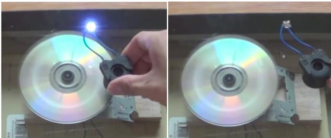
Gambar 5. Lampu yang terhubung pada koil menyala pada lintasan magnet yang berputar
