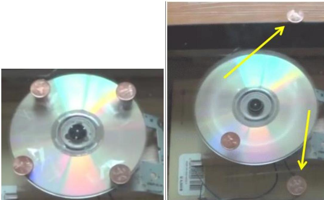
Gambar 3. (a) uang logam ditempatkan di atas kaca pada lintasan magnet (b) uang logam terlempar dengan arah tangensial
