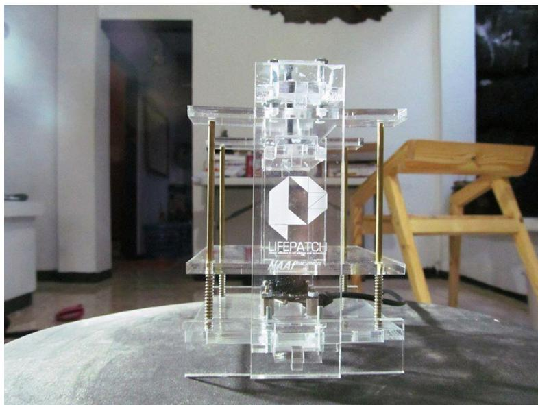
Gambar 2 Alpha Micam (mikroskop dari web cam yang dikembangkan oleh Nur Akbar Arofatullah dari Lifepatch)
