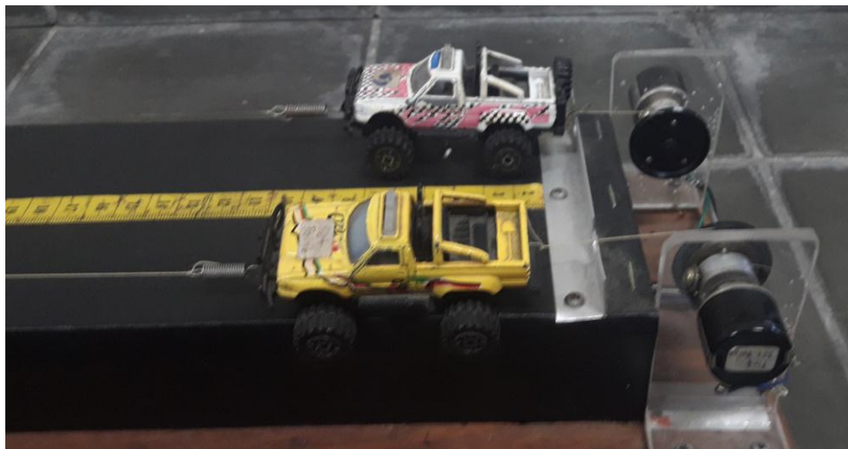
Gambar 6 Sensor posisi (potensio) yang terpasang pada miniatur mobil
