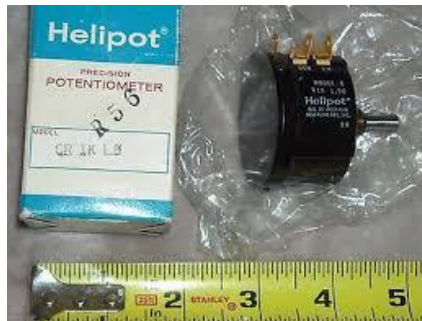
Gambar 5 Potensio multi turn (10 putaran) sebagai Sensor Posisi
