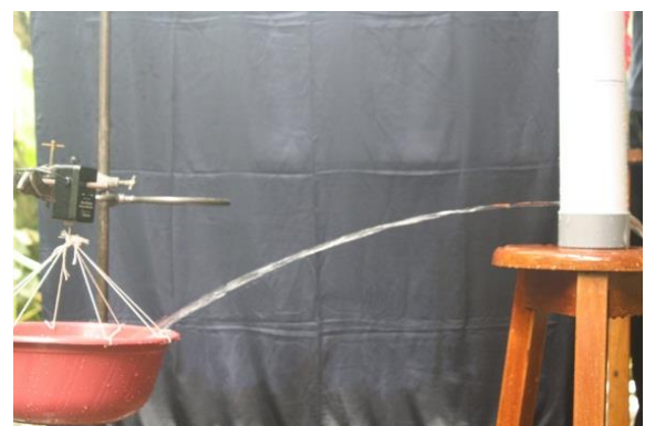
Gambar 2. Susunan peralatan yang digunakan. Sensor gaya terlihat di samping kiri.
