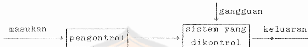
Gambar 6.2 Diagram blok sistem kontrol lup terbuka
