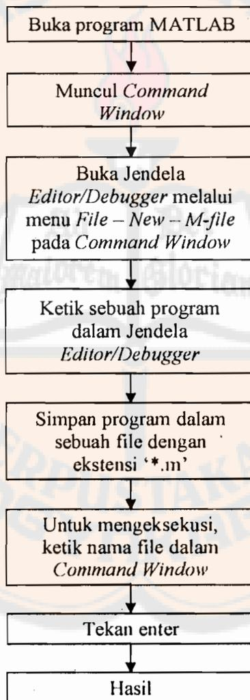
Diagram II.2. Diagram Langkah Menggunakan Modus Program
