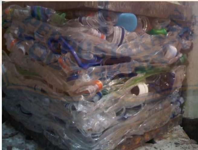
2. Gambar limbah botol plastik pada saat pengepresan
