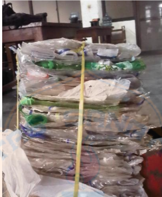
3. Gambar limbah botol plastik setelah pengepresan
