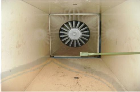
Gambar 13. Terowongan Angin atau Wind Tunnel
