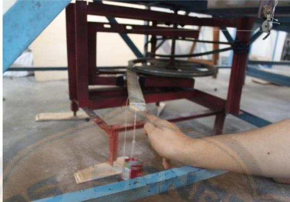
Gambar 10. Sistem Pembebanan
