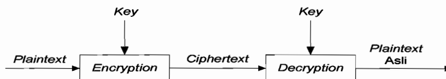
Gambar 2.2 Proses enkripsi-dekripsi dengan kunci
