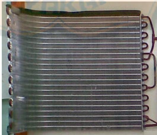
**Gambar 2.4** Kondensor jenis pipa dengan sirip-sirip
