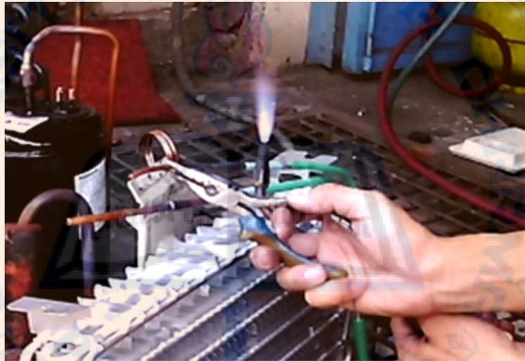
**Gambar 3.27** Proses Pengelasan Evaporator dengan Kompresor
