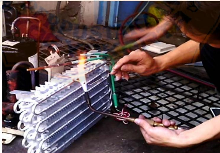
**Gambar 3.26** Proses Pengelasan Pipa Kapiler dengan Evaporator
