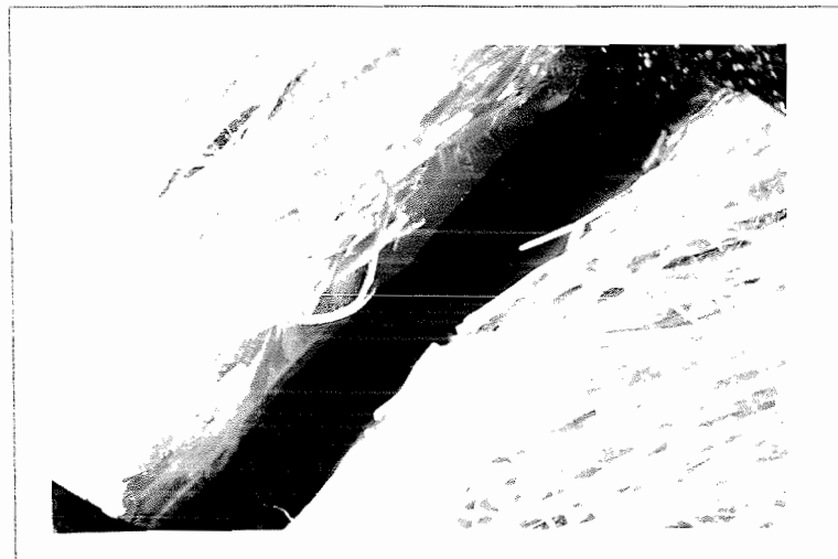
Gambar 4.12. Foto Makro Bentuk Patahan pada Komposit dengan Fraksi Berat Serat 4%
