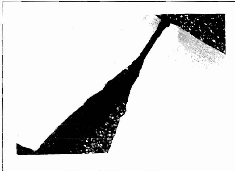
Gambar 4.13. Foto Makro Bentuk Patahan pada Matrik Pengikat
