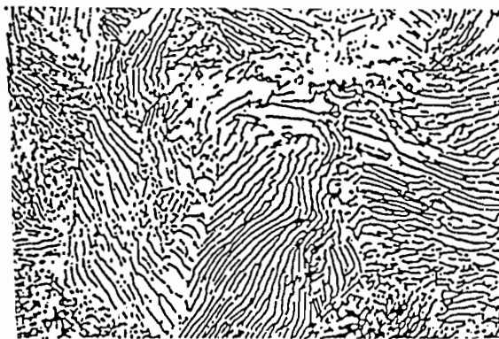
Gambar 2.2. Struktur Mikro Perlit-Campuran Ferit dan Fe 3 C Sumber : Teknik Pengecoran Logam, Tata Surdia & Kenji Chijiwa
