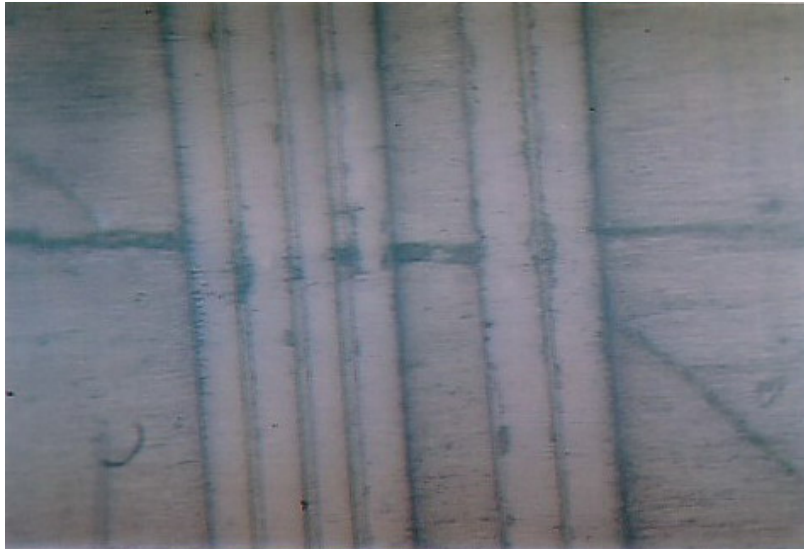
Gambar 4.13. Retak melintang pada komposit
