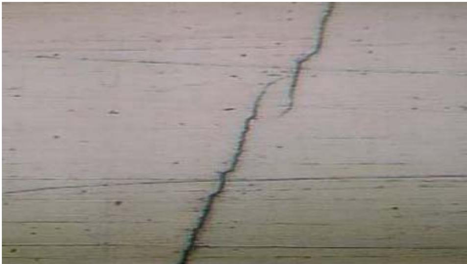
**Gambar 4.10.** Retak Mikro pada Matrik (perbesaran 200x).
