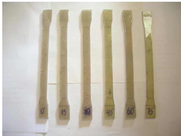
**Gambar 3.11. Foto benda uji tarik komposit pada berbagai arah orientasi serat.**
