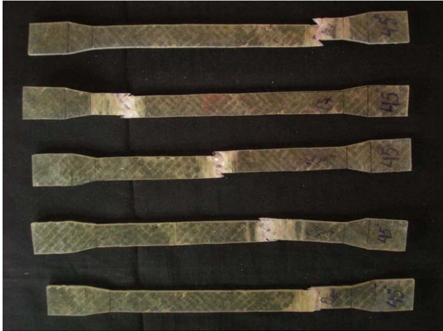
**Gambar 4.15. Foto Makro Bentuk Patahan Komposit Pada Orientasi Arah Serat 45°.**
