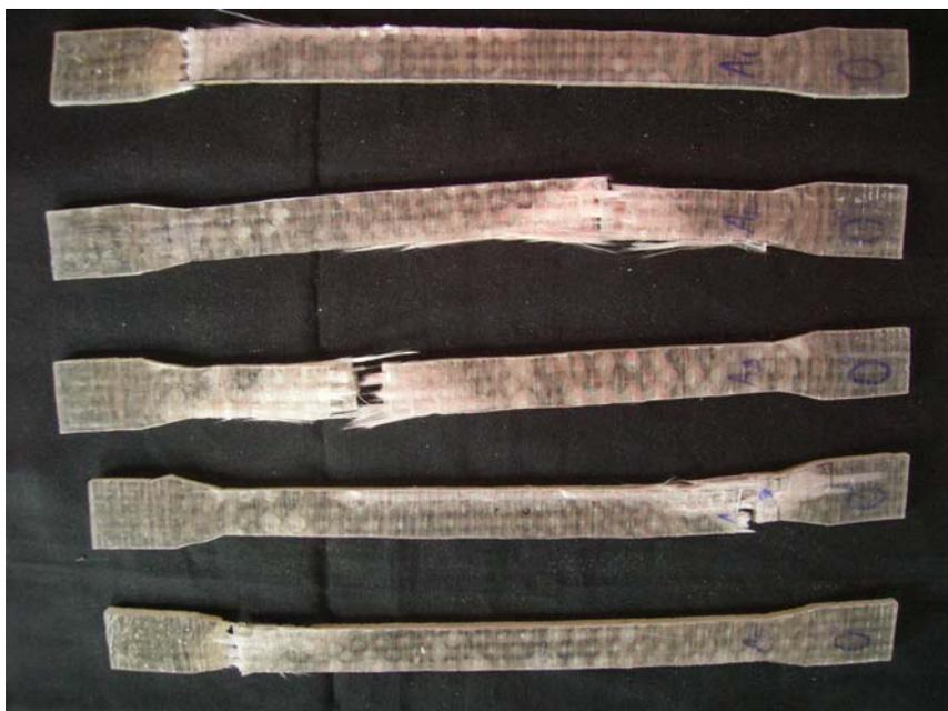
**Gambar 4.12. Foto Makro Bentuk Patahan Komposit Pada Orientasi Arah Serat 0°.**
