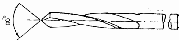
Gambar 1. 7, Jenis bor pilin untuk bahan marmer
