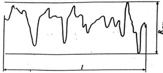
Sumber : Sato, Menggambar mesin menurut standar ISO, bab 15 Gambar 2.6. Tinggi Maksimum R_a dari Ketidakrataan.
