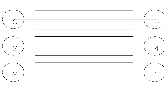
Gambar 3.4. Urutan Pengerjaan dengan Alat Potong Kedua.
