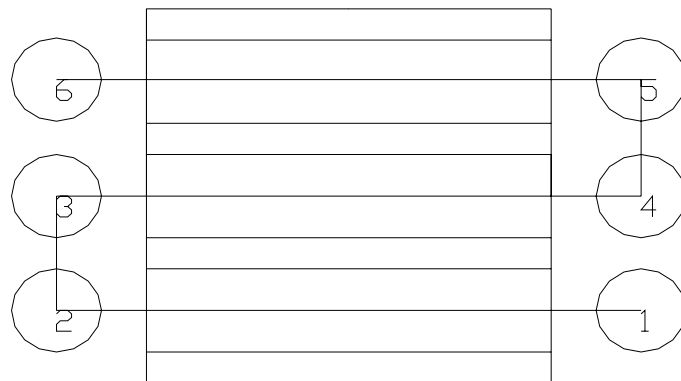
Gambar 3. 3. Urutan Pengerjaan dengan Alat Potong Pertama.
