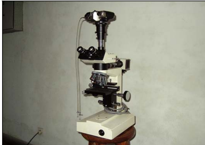
Gambar 3.7 Mikroskop mikro dilengkapi dengan kamera
