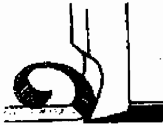
Gambar 3. Bentuk chip selama pemotongan pada mesin sekrup
