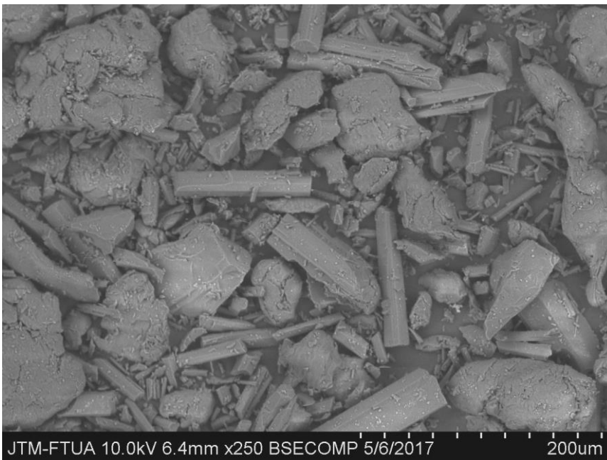
c. SEM Campuran Fisik dengan perbesaran 250x
