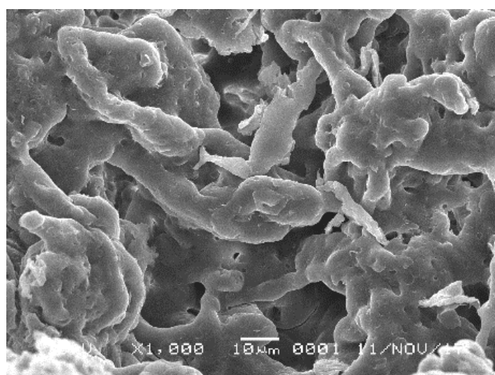
Gambar 2. Hasil SEM mikrokapsul tanpa zat aktif
