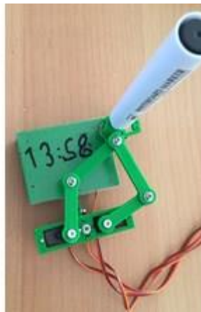
Gambar 1. Contoh mekanisme pantograf pada robot penggambar (sumber Thingiverse Plotter/Drawbot Collection)
