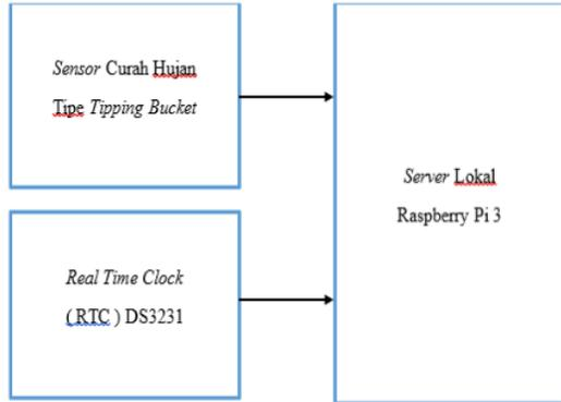
Gambar 3 Skema Konfigurasi Server Lokal
