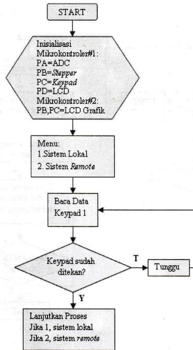
Gambar 3. *Flow Chart* Program Utama pada Mikrokontroler
