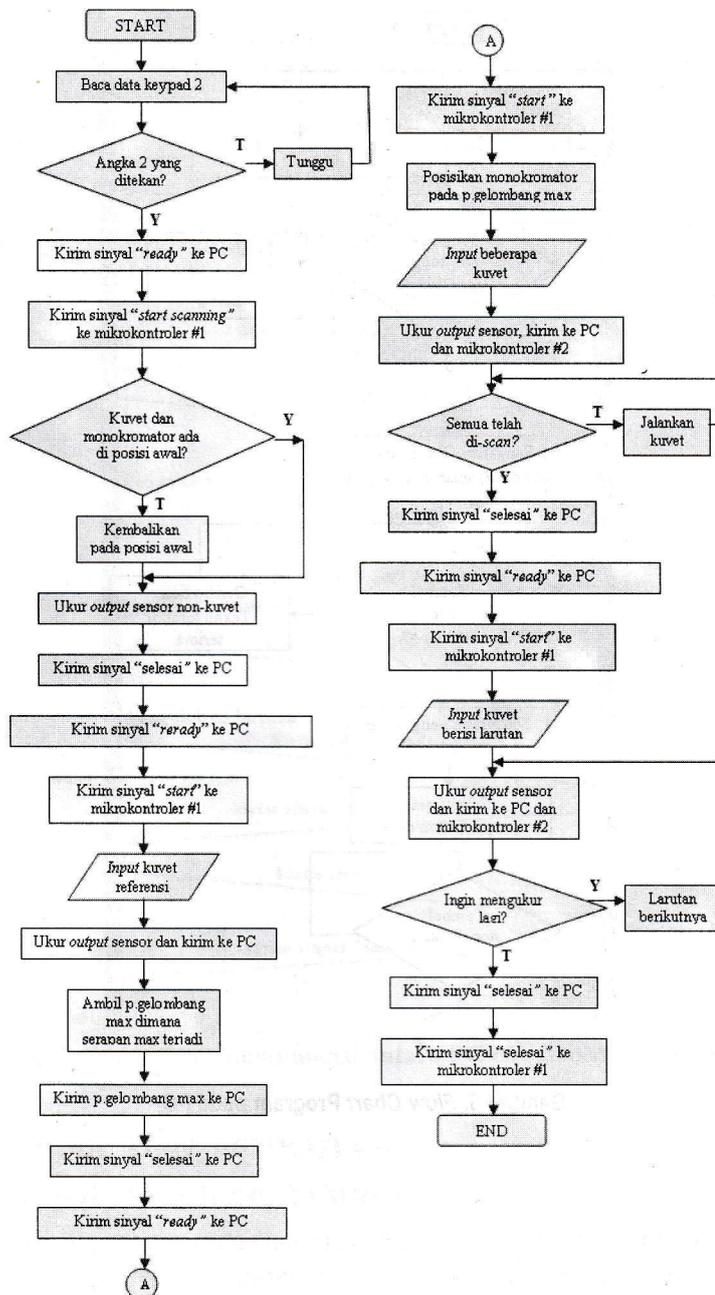
Gambar 5. Flow Chart Program Sistem Remote pada Mikrokontroler
