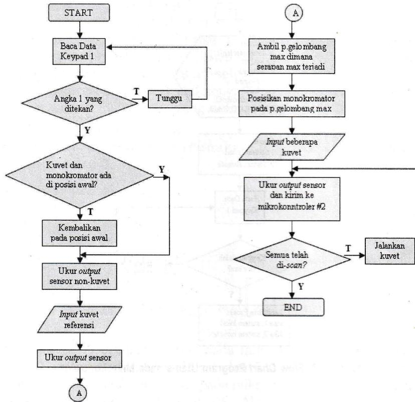
Gambar 4. Flow Chart Program Sistem Lokal pada Mikrokontroler
