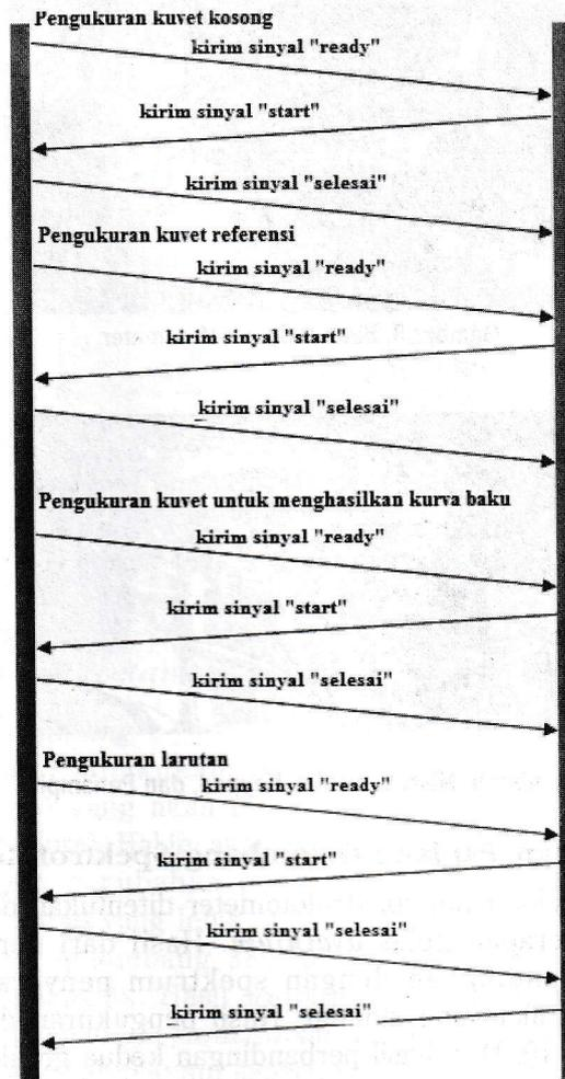
Gambar 7. Alur Komunikasi antara PC dan Mikrokontroler
