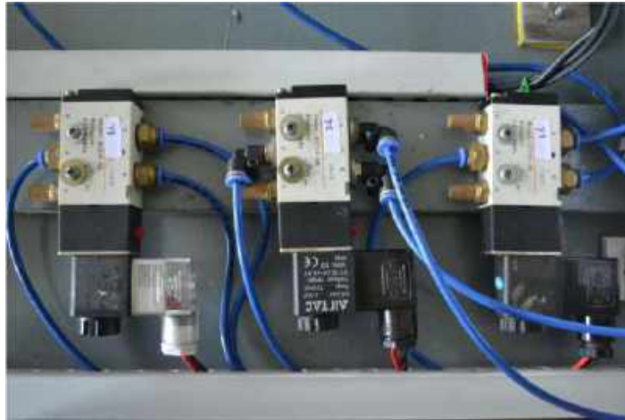
Gambar : Solenoid (y1,y2,y3) sebagai penggerak cylinder
