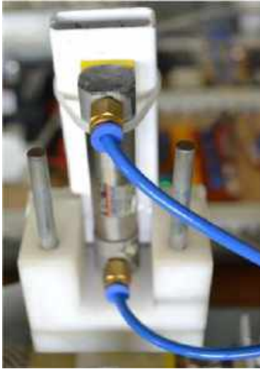
Gambar : cylinder 2 sebagai stamping
