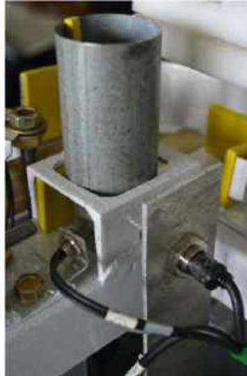
Gambar : Magazine dengan sensor kapasitif, induktif dan optic
