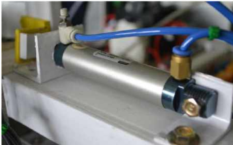
Gambar : cylinder 3 sebagai pendorong menuju konveor
