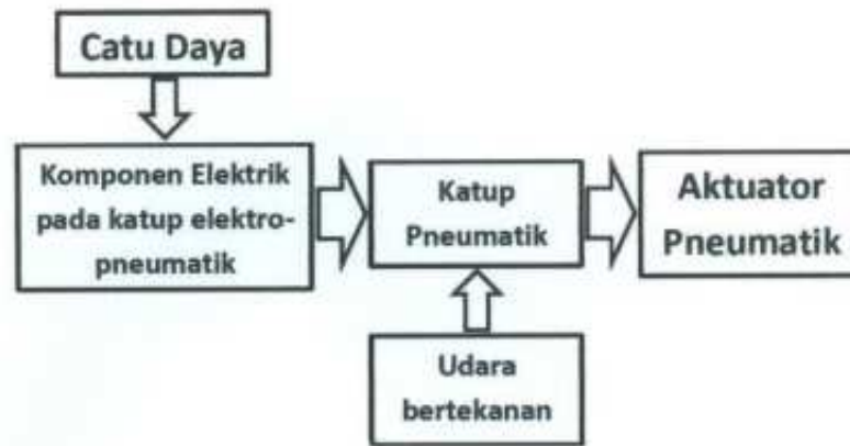
Gambar 2. Diagram blok Katup Pneumatik sebagai piranti terkendali
