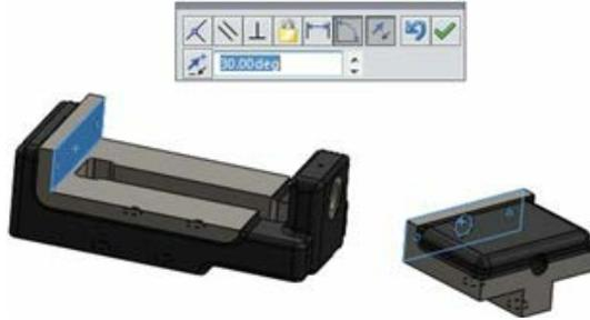
Gambar 77. *Mate* dengan batasan *angle*
