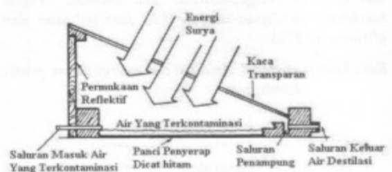
Gambar 1. Skema alat destilasi energi surya yang umum
