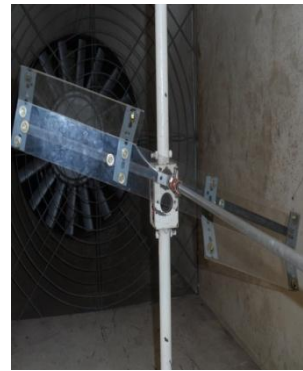
Gambar 5. (a) Gambar dimensi kincir penelitian, (b) Penempatan kincir dalam terowongan angin ( wind tunnel )
