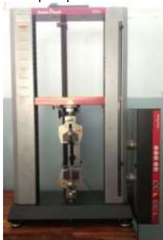
Gambar 6. Mesin Uji tarik ZwickRoell Z020
