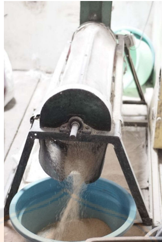
Gambar 3. 4 Mesin Pembersih Biji Wijen
