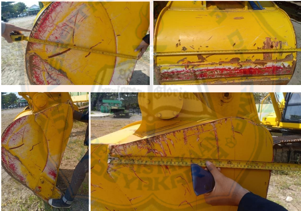
Lampiran 2 Proses pengukuran dimensi bucket
