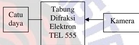
Gambar 2. susunan peralatan yang digunakan dalam eksperimen
