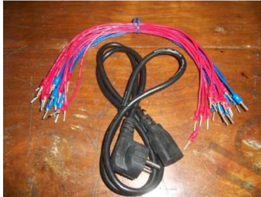
Gambar 8.6 Kabel Power dan Kabel Jumper Pengawatan modul Sensor Level
