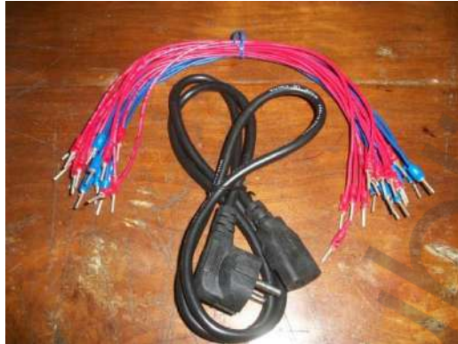
Gambar 5.8. Kabel Power dan Kabel Jumper Pengawatan modul Sensor photo electric
