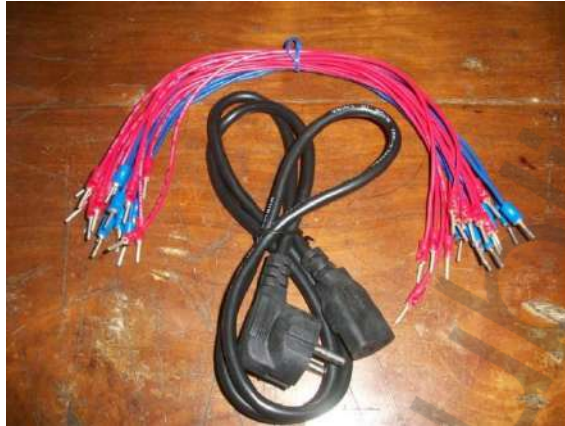
Gambar 7.6. Kabel Power dan Kabel Jumper Pengawatan modul Sensor Rotary Encoder
