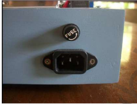
Gambar 3.6 Konektor Sumber Listrik 220 VAC, Sekering
