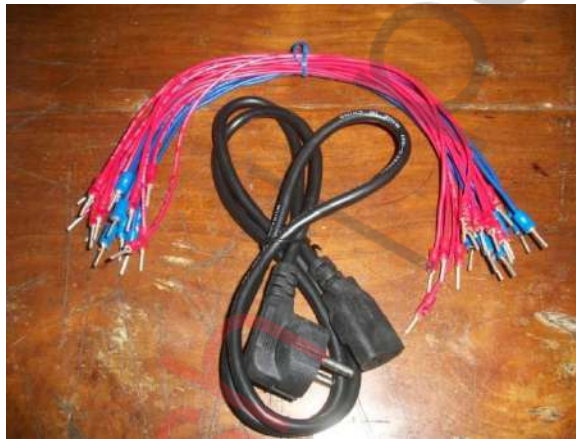
Gambar 3.7. Kabel Power dan Kabel Jumper Pengawatan modul Sensor Induktif
