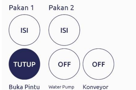
Gambar 14. Tampilan Kondisi Tombol Tutup Pintu pada Blynk
