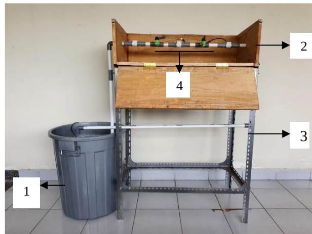
Gambar 2. Tampilan prototipe kebocoran pipa di dalam tanah.
