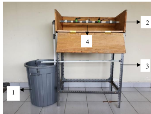
Gambar 2. Tampilan prototipe kebocoran pipa di dalam tanah.
