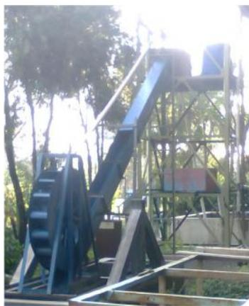
Gambar 7. Bentuk Alat Uji Coba Kincir Air
