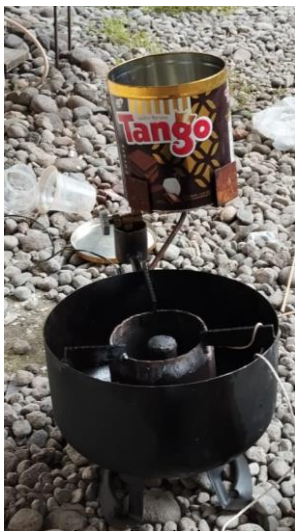
Gambar 3. Kompur berbahan bakar minyak jelantah
