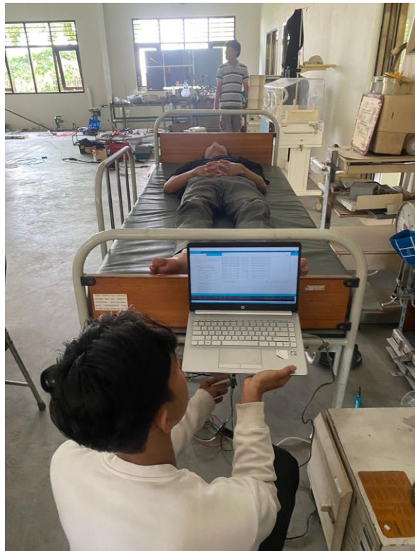
Gambar 8. Pengujian sensor berat badan pasien
