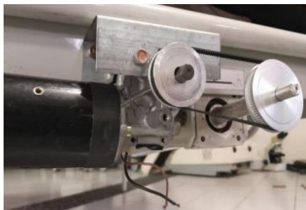
Gambar 5. Sistem penggerak motor menggunakan belt
