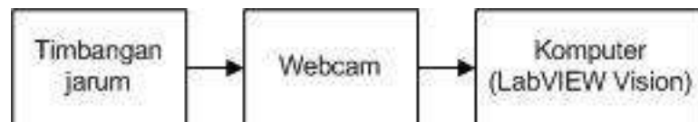
Gambar 1. Blok diagram datalogger timbangan jarum
