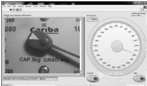
Gambar 8. Posisi jarum timbangan dapat terbaca dengan tepat
