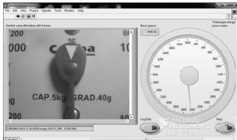
Gambar 10. Nilai berat ditampilkan dalam bentuk angka dan visualisasi jarum meter
