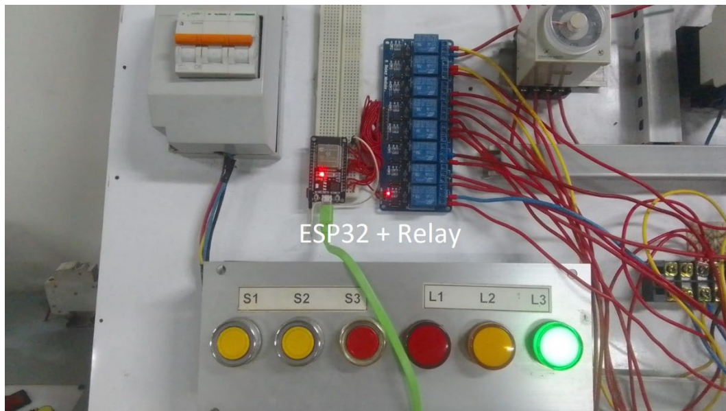
Gambar 4. Pemasangan perangkat ESP32 + Relay, yang digunakan untuk mengontrol rangkaian pengawatan dari jarak jauh
