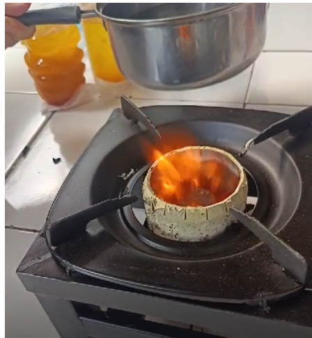
Gambar 2. Kompur dengan bahan bakar minyak jelantah yang sudah diolah menjadi biodiesel
