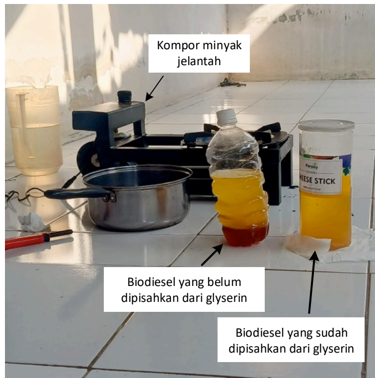
Gambar 1. Kompur dengan bahan bakar minyak jelantah yang sudah diolah menjadi biodiesel
