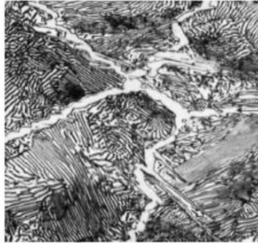
Gambar 2. 9 Struktur mikro Cementite pada baja karbon 1,4 wt% C
