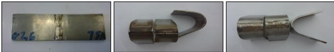
Gambar 5. Hasil pengelasan (kiri), hasil uji tekuk root bend (tengah) dan face bend (kanan)
