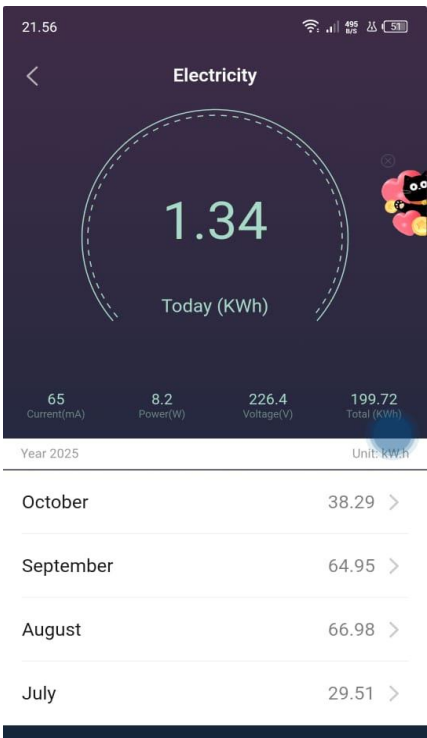
Gambar 6. tampilan energi meter smart plug
