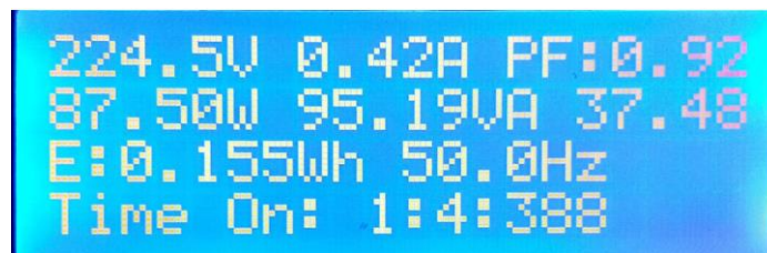
Gambar 4. Tampilan Energi meter menggunakan LCD 4x20
