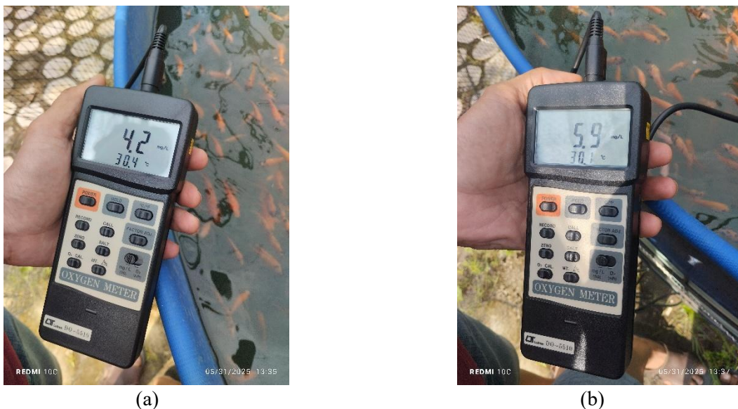
Gambar 5. Pengukuran Konsentrasi DO Air Kolam Budidaya (a) tanpa Mengoperasikan MBG; (b) engan Mengoperasikan MGB
