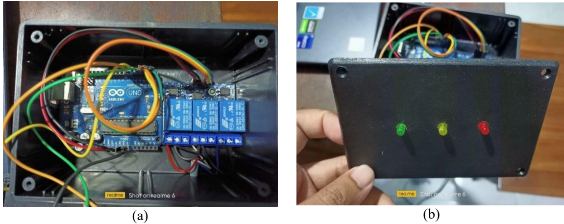
Gambar 9. Perangkat keras system pengendali kecepatan
