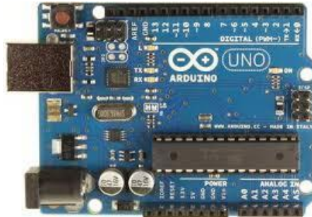
Gambar 2. Pengendali mikro Arduino UNO
