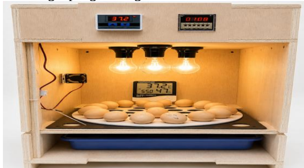
Gambar 3. Inkubator telur ayam otomatis hasil penerapan teknologi tepat guna dengan komponen pengendalian suhu, pemanas, sirkulasi udara, dan mekanisme pembalikan telur.
